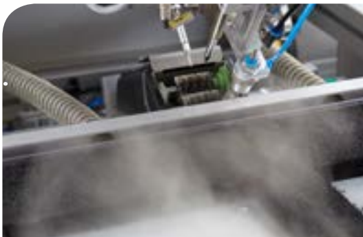
Die integrierte Lötrauchabsaugung schützt 3-fach gegen Schadstoffe; den Anwender, das Werkstück und die Maschine.
