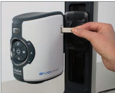
Schnelle Speicherung von Bildaufnahmen via USB-Stick (ohne PC).
